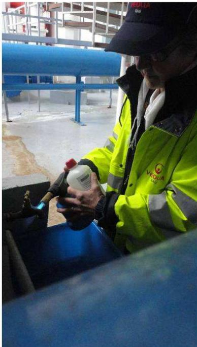
Opération de prélèvement d'échantillons d'eau brute ou d'eau traitée, pour les analyses des conformités physico chimiques ou bactériologiques.
