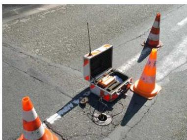
Les recherches de fuites régulières permettent de réduire les pertes en eau en améliorant le rendement du réseau. Des appareils autonomes d'écoute de nuit installés
