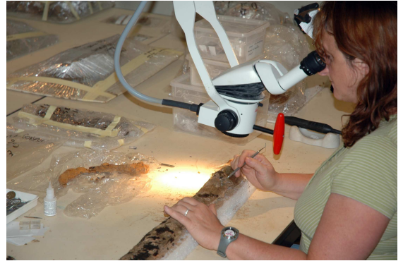
Observation à la loupe binoculaire et dégagement de la corrosion sur une épée.
