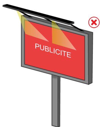
Dispositif d'éclairage sous forme de rampe d'éclairage
